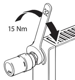
Die Montage des Fühlerelements auf dem Heizkörperventil erfolgt durch Anziehen der Überwurfmutter mit Hilfe eines Maulschlüssels (SW 32)
