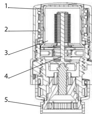
Die Fühler arbeiten mit einem flüssigkeitsgefüllten Wellrohrelement, das von der Raumtemperatur direkt gesteuert wird. Wenn die Raumtemperatur sinkt, zieht sich das Wellrohr im thermostatischen Element zusammen und öffnet das Ventil. Dadurch wird die Wärmezufuhr zum Heizkörper gerade um soviel erhöht, wie für die gewünschte Raumtemperatur erforderlich ist.
